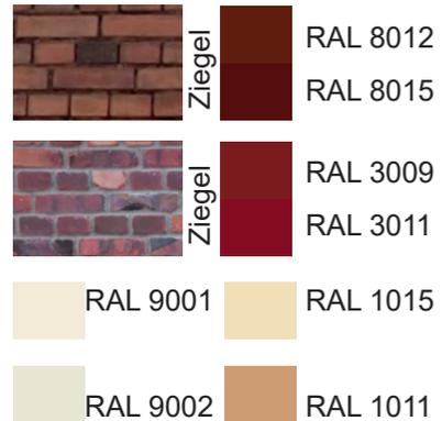
ABBILDUNG 15 FARBRICHTWERTE DER FASSADEN (OBEN ZIEGEL, UNTEN PUTZ)
