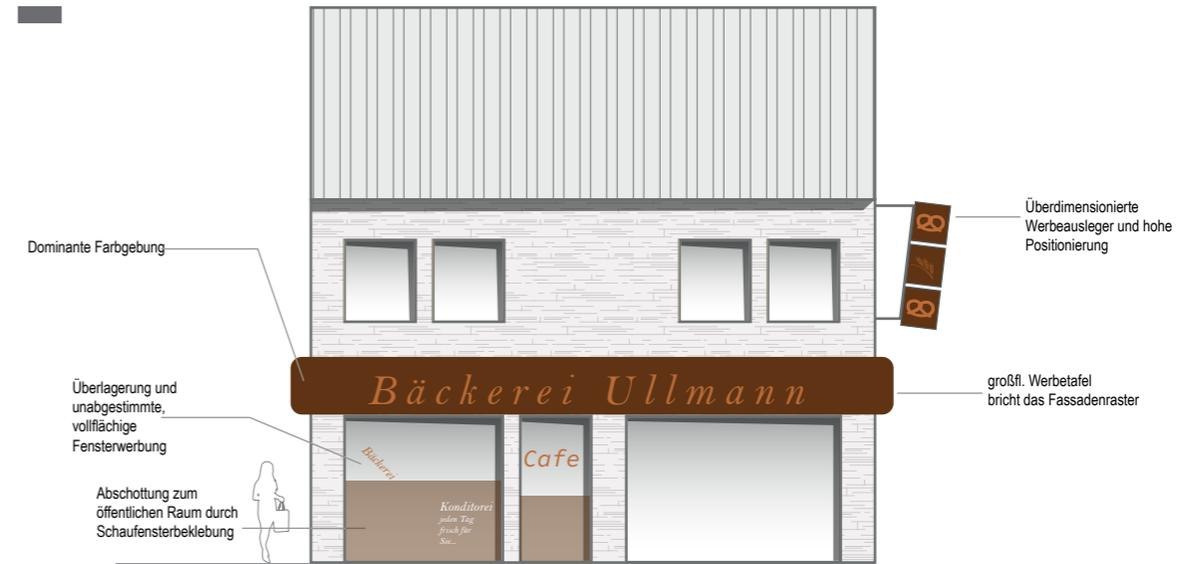
ABBILDUNG 58 SCHEMATISCHE DARSTELLUNG EINER NEGATIVEN AUSFÜHRUNG VON WERBEANLAGEN
