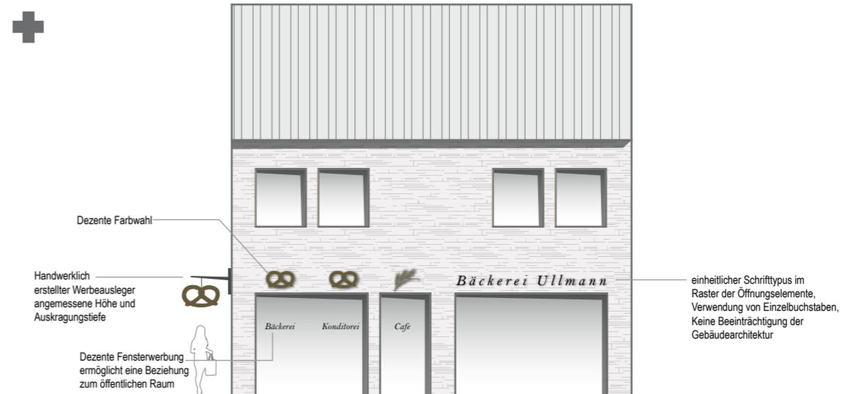
ABBILDUNG 59 SCHEMATISCHE DARSTELLUNG EINER POSITIVEN AUSFÜHRUNG VON WERBEANLAGEN
